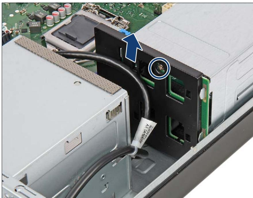
図 37: 配電ボードの取り外し
