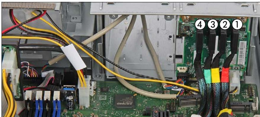
図 68: 例 : ケーブルの接続 - PCIe ケーブルをバックプレーン 1 へ
