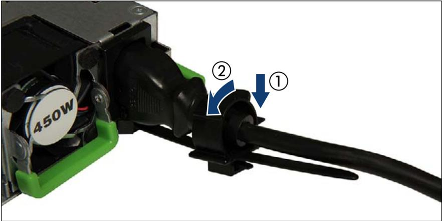
図 3: PSU のケーブルクランプのロック解除
