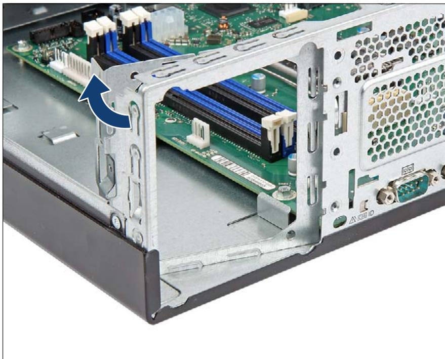
図 44: 標準 PSU フレームの取り外し (B)
