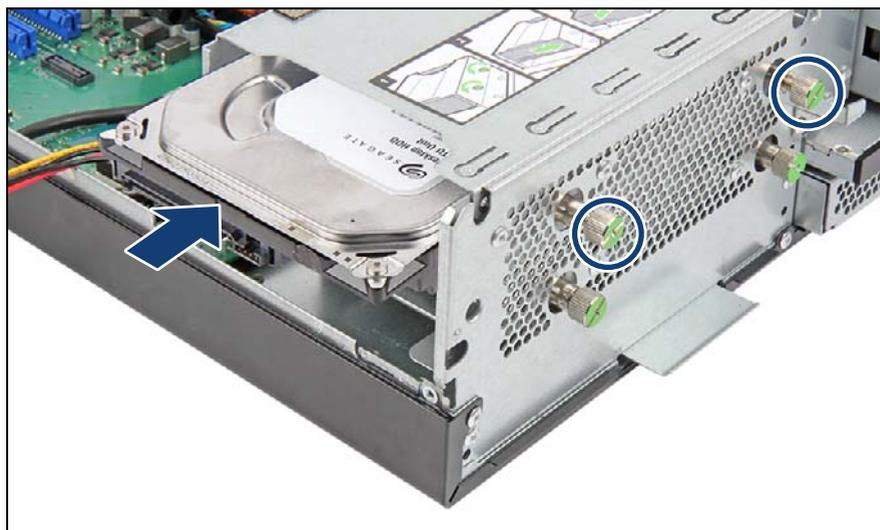
図 52: 3.5 インチホットプラグ非対応 HDD の挿入 (A)
