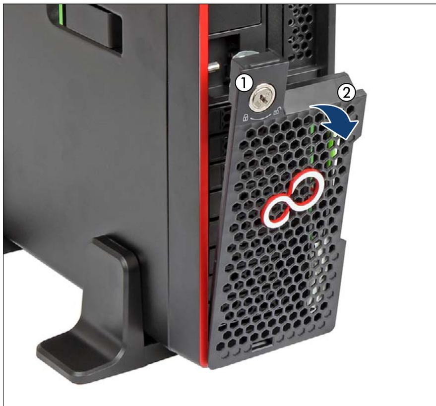
図 9: HDD ベイカバーの取り外し
