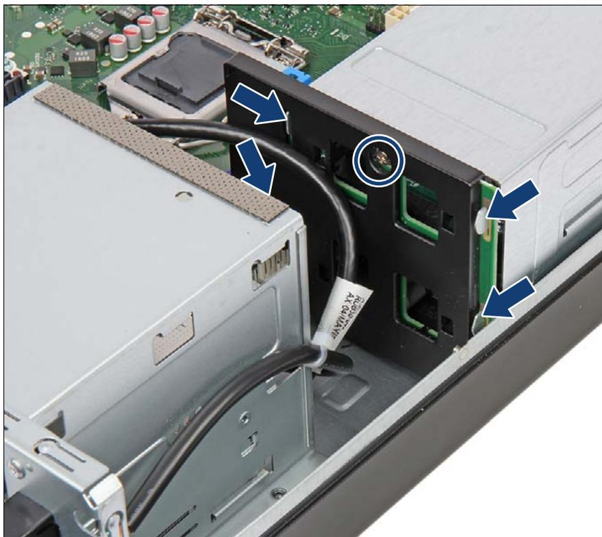
図 39: 配電ボードの取り付け (A)
