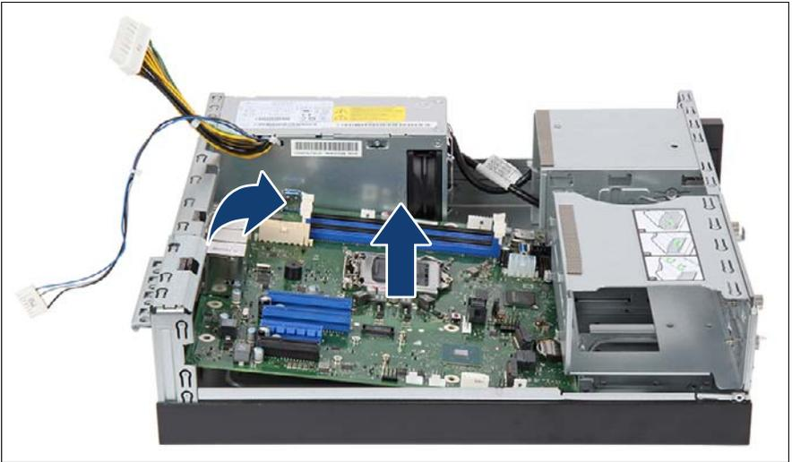
図 187: システムボードの取り外し
