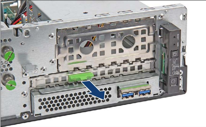
図 139: ODD フィラーカバーの取り外し
