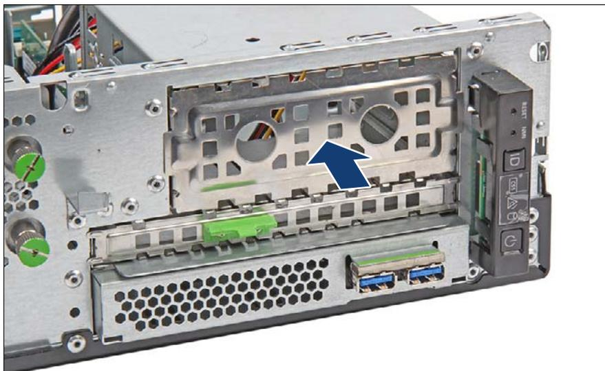
図 155: ドライブフィルターカバーの挿入
