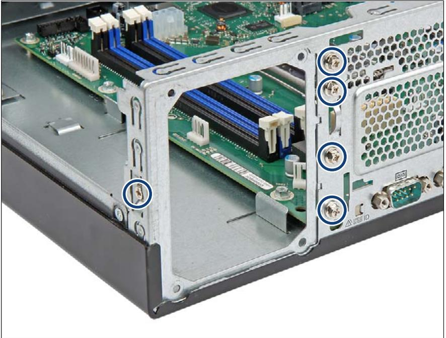
図 43: 標準 PSU フレームの取り外し (A)
