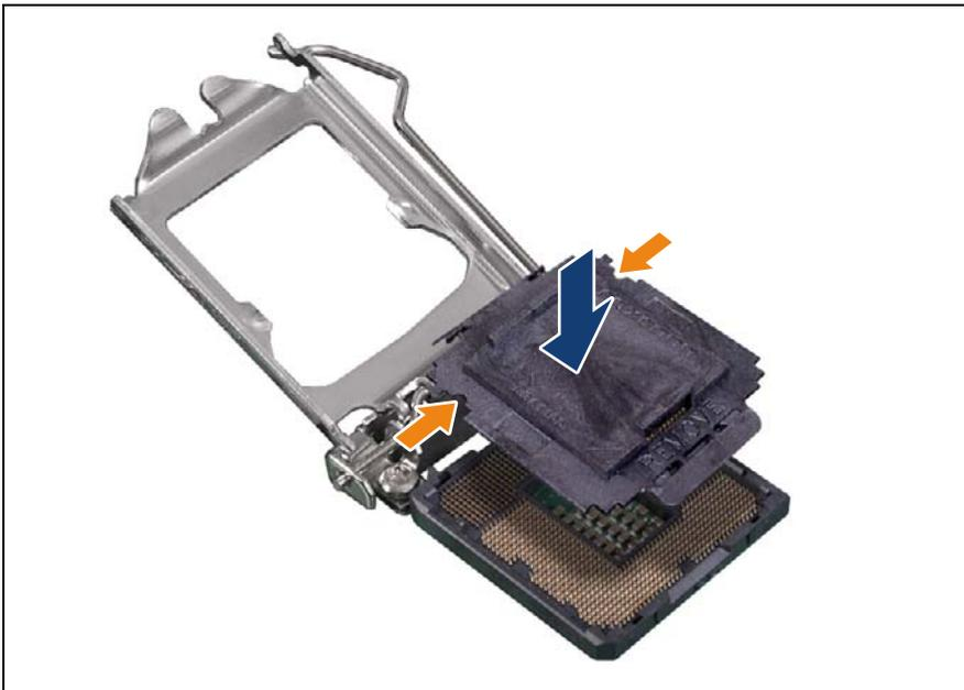
図 131: ソケット保護カバーの取り付け
