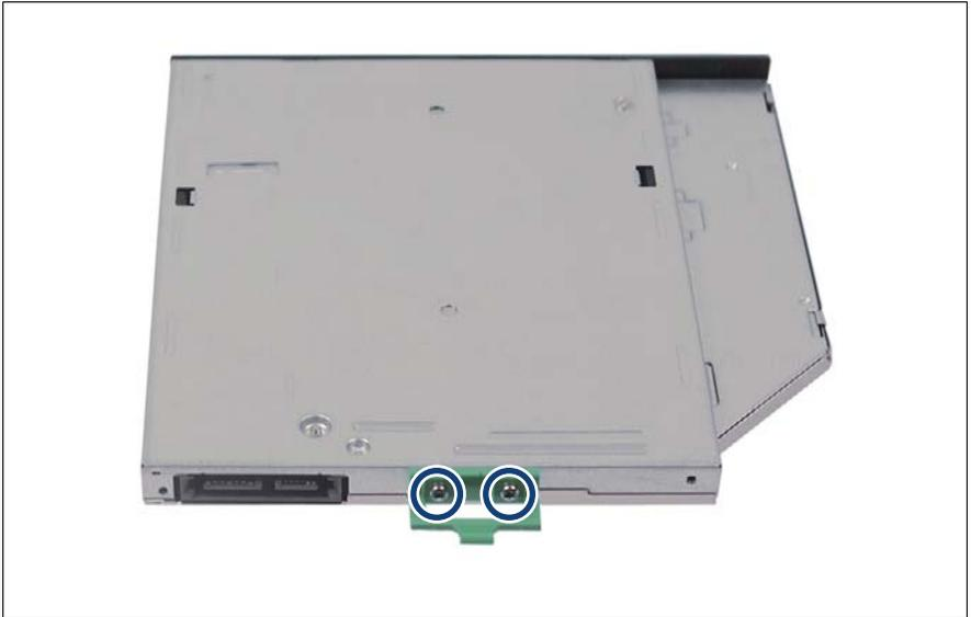
図 141: ODD への ODD ラッチの取り付け
