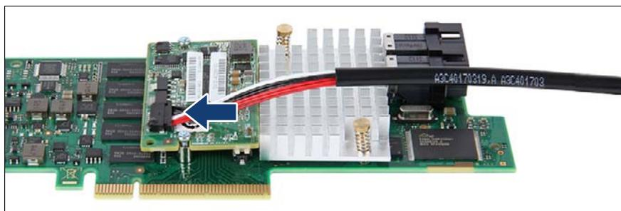
図 102: FBU アダプタケーブルの接続
