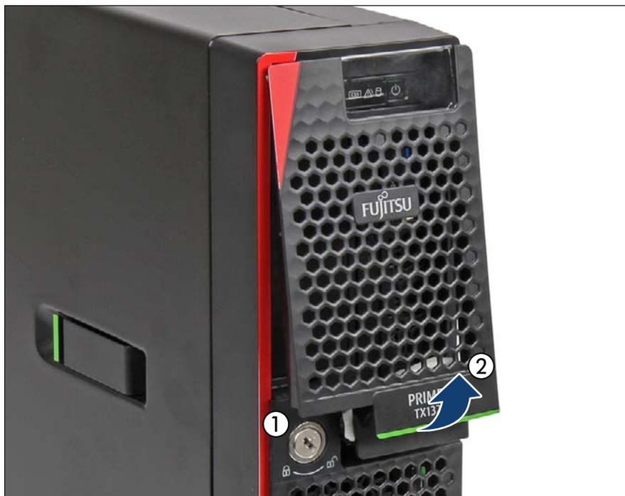
図 7: アクセス可能なドライブベイカバーの取り外し
