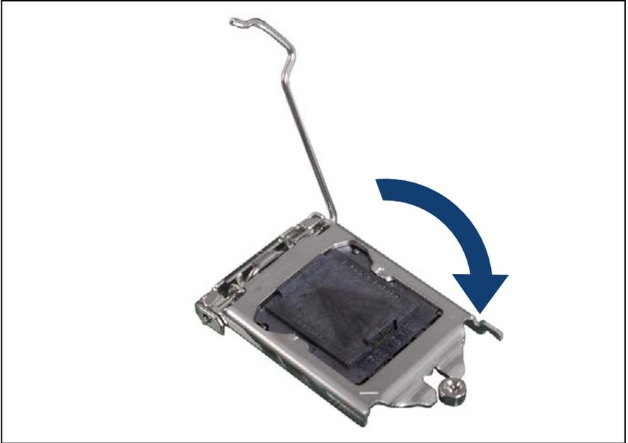
図 132: ロードプレートを閉じる (A)
