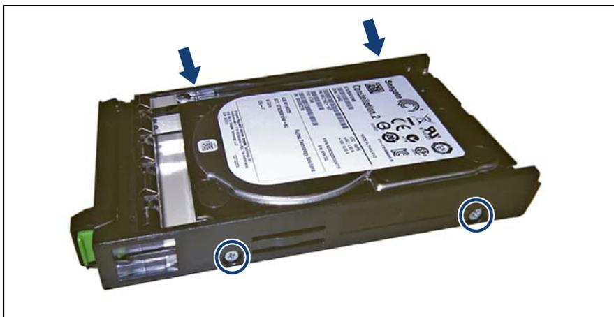
図 50: 2.5 インチ HDD/SSD トレイへの 2.5 インチ HDD/SSD の取り付け (B)
