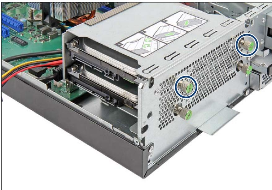
図 53: 3.5 インチホットプラグ非対応 HDD の挿入 (B)
