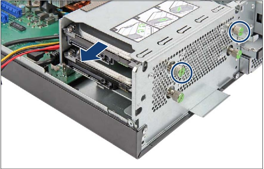
図 56: 3.5 インチホットプラグ非対応 HDD の取り外し
