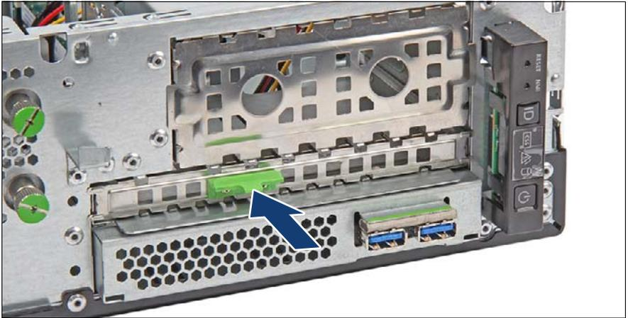
図 148: ODD フィラーカバーの取り付け
