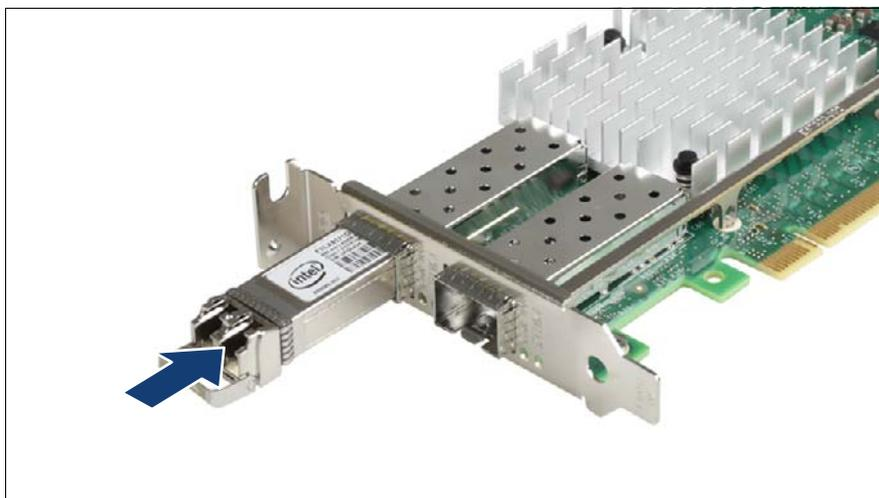
図 83: SFP+ トランシーバモジュールの挿入
