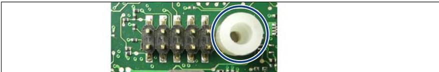
図 166: システムボードへの TPM スペースターの挿入
