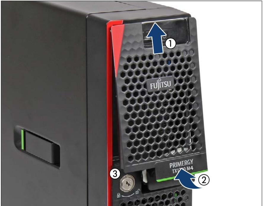
図 12: アクセス可能なドライブベイカバーの取り付け
