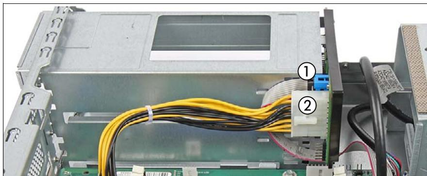
図 36: 配電ボードからケーブルの取り外し
