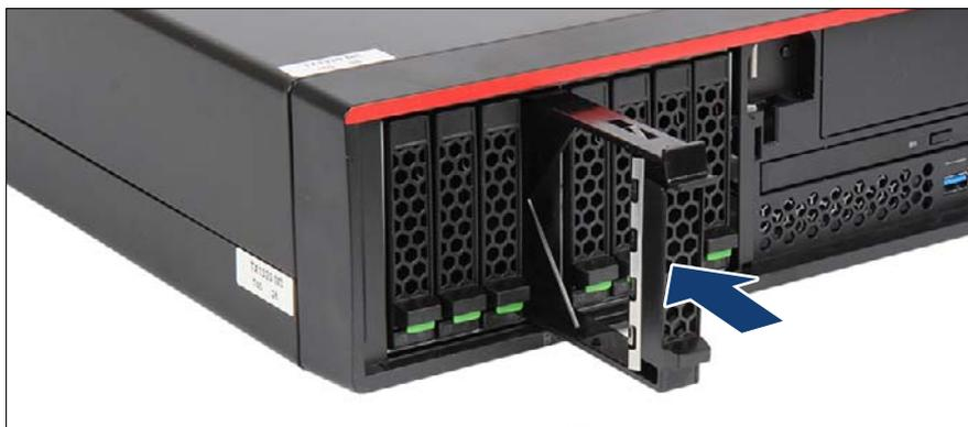
図 63: 2.5 インチ HDD/SSD ダミーモジュールの取り付け
