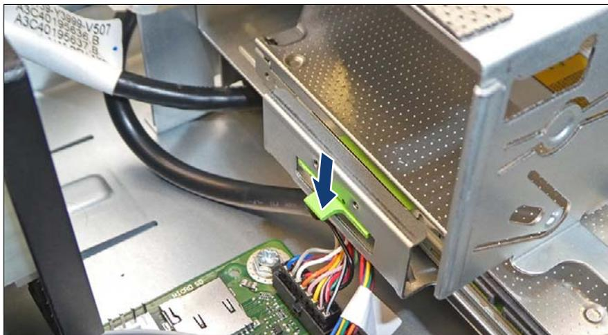
図 143: ODD の取り付け (B)
