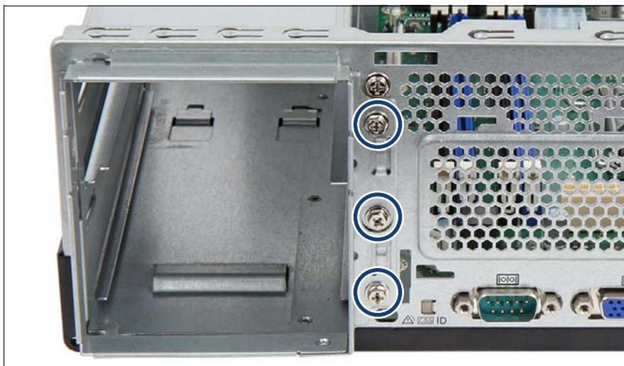
図 47: 冗長 PSU フレームの取り付け (B)
