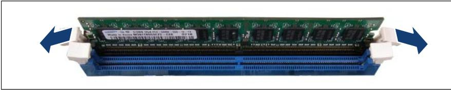
図 115: メモリモジュールの取り外し (A)
