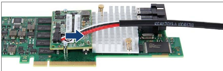
図 98: TFM からの FBU アダプターケーブルの取り外し
