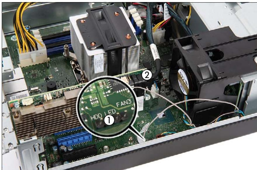
図 93: HDD LED ケーブルと SAS ケーブルの接続
