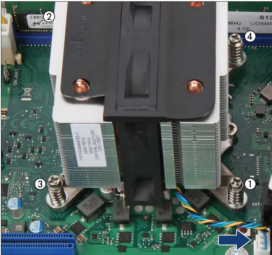
図 129: ヒートシンクバリエーション 1 の取り付け
