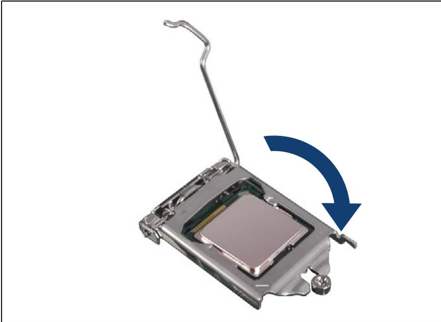
図 124: ロードプレートを閉じる (A)
