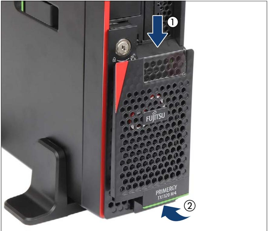
図 8: アクセス可能なドライブベイカバーの HDD ベイカバー前面への配置
